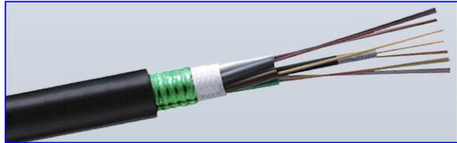
防水化合物。松套管外用一层双面涂塑钢带纵包，钢带和松套管之间加阻水材料以保证光缆的紧凑和纵向阻水， 两侧放置两根平行钢丝后护套成缆。
